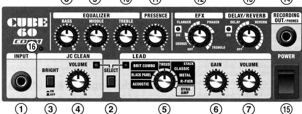
1. INPUT – Ulazni priključak – za priključivanje gitare
