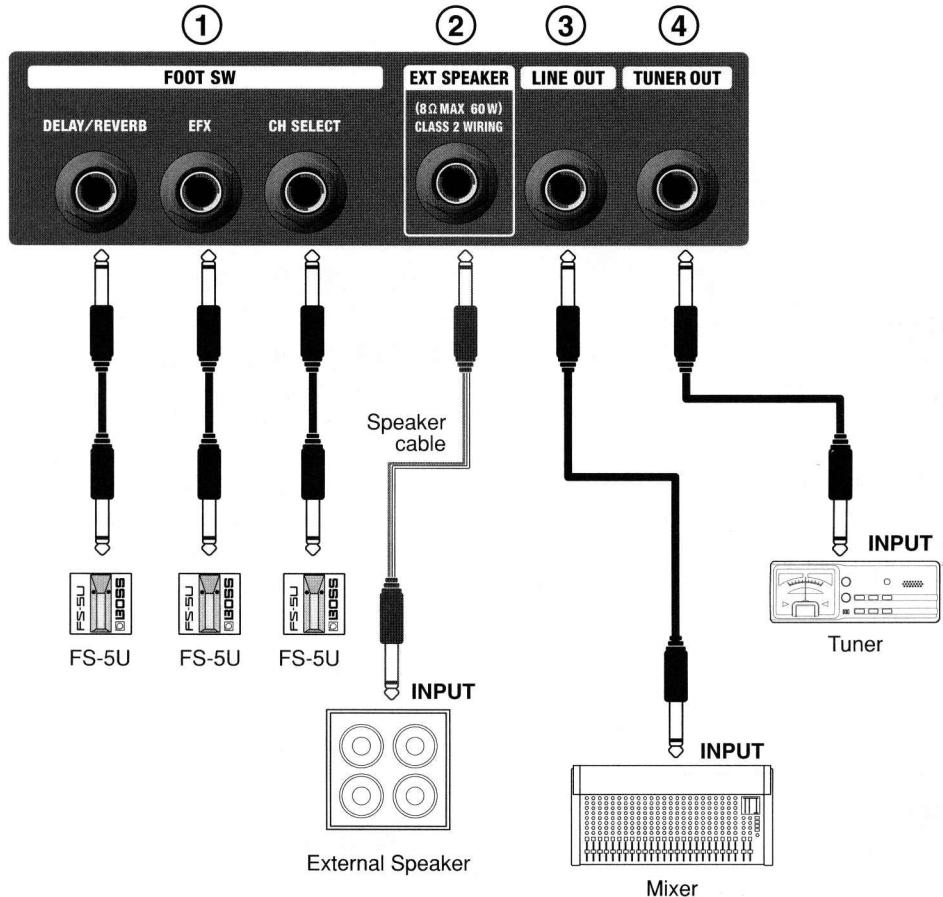
1. FOOT SW priključak za pedale Pri povezivanju koristite samo zvučničke na koji se uz pomoć kabla mogu kablove, a ne linijske. povezati pedale (BOSS FS-5U). Polaritet podešiti kao na slici:
