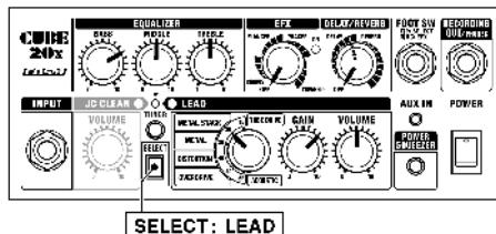
Sjajan za jake, oštре akorde. Izaberite high-gain R-FIER amp, i equalizerom dodatno pojačajte basove. Ako se kombinuje sa duplim magnetom u zadnjem položaju rezultat će biti ekstremno izobličenje. Ako se doda jači delay može se koristiti kao solo sa jakim sostenutom, dok sa manjim delay-om dobijate zvuk kao da se čuju 2 gitare istovremeno.
