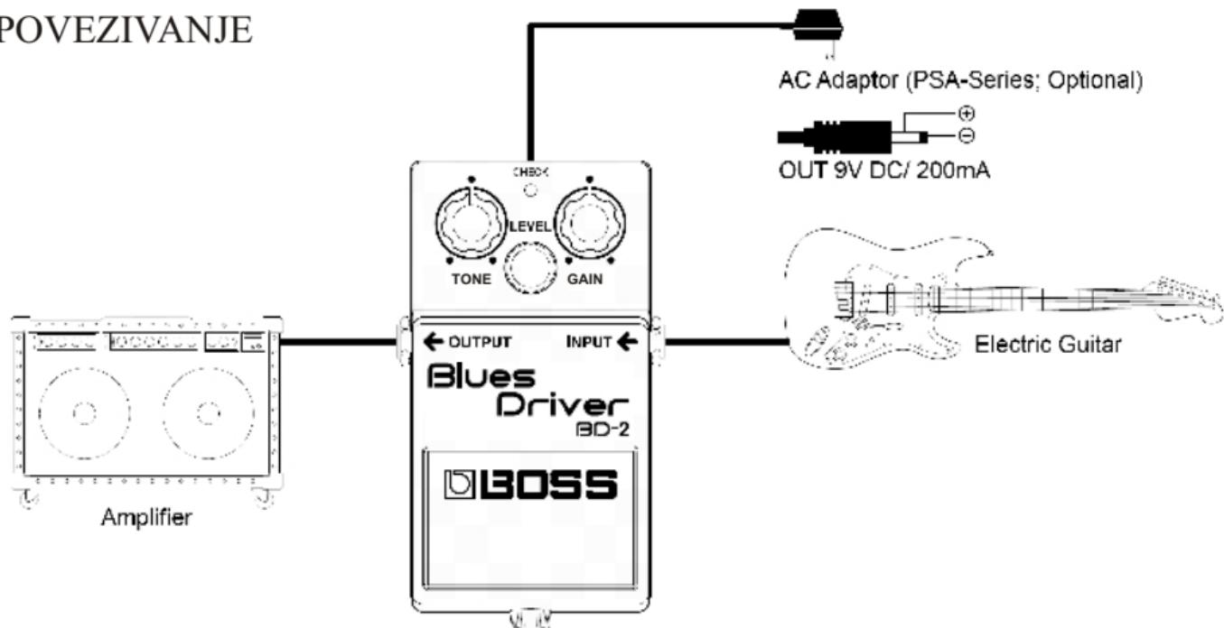
\* Uključivanjem utikača u Input ulaz automatski uključuje pedalu.
