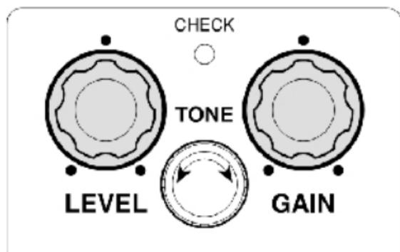
5.Pomoću LEVEL potencometra podesite jačinu tako da nema razlike između jačine zvuka efekta i čistog zvuka gitare.
