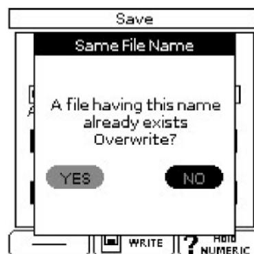
Ako želite točkićem izaberite "YES" i pritiskom na [ENTER/ SELECT] potvrdite izbor, i stari fajl će biti zamjenjen novim.
