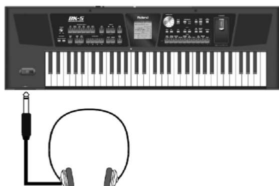
1. Slušalice treba uključiti u PHONES 1 ili 2 priključak na levoj strani prednjeg panela BK-5. Čim se uključe slušalice, prekida se zvuk sa ugrađenih zvučnika.
