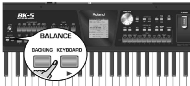
Kad se pritisnu [BACKING] ili [KEYBOARD] tasteri, prikazuje se "BALANCE" prozorčić sa trenutnim postavkama parametara:
